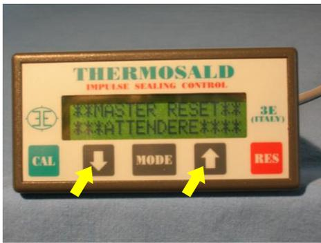
Con Master Reset il termoregolatore si autoconfigura secondo la struttura hardware presente. I parametri vengono inizializzati come all'uscita dalla fabbrica: se qualche parametro è stato modificato occorre riportarlo alla condizione di lavoro.
