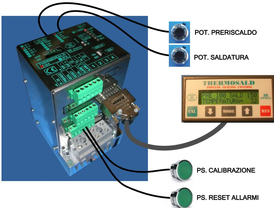
NOTA 1: per abilitare i potenziometri impostare il DATO MACCHINA CONFIGURAZIONE=1 potenziometri+display.
