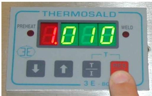
Sul display compare la dicitura H100, per indicare che è in corso la prima fase di riscaldamento a 100 gradi. Successivamente compariranno in sequenza le diciture H160, H100, H160, H100, H160, H100 per indicare I cicli di riscaldamento / raffreddamento della piattina a 160 e 100 gradi. Al termine del ciclo il termoregolatore è pronto per lavorare. Il ciclo di burn può essere interrotto premendo il pulsante di reset.
